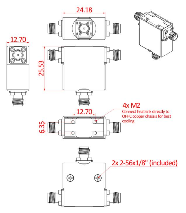
Datasheet LNF-ISC4\_8A and LNF-CIC4\_8A 4-8 GHz Cryogenic Isolator or Circulator
